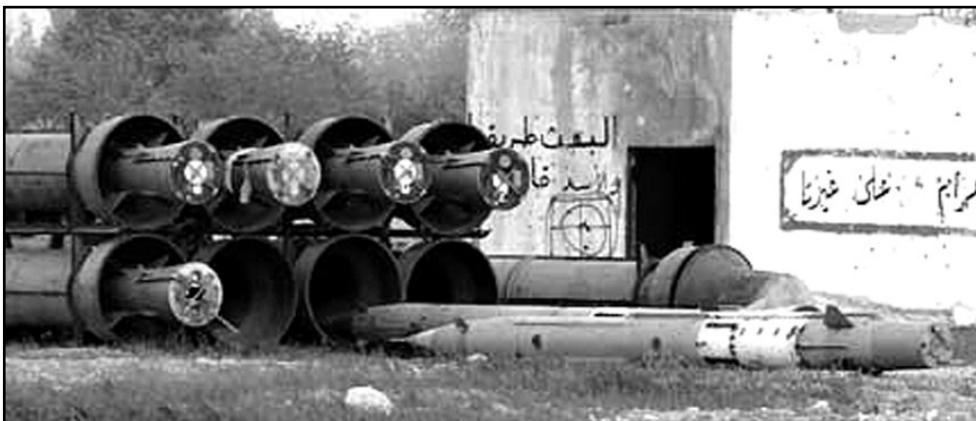
SVZ am 14.04.2013: Aufklärungsfoto von "Experten" aus Syrien. An diesem Ort sollen Reste des chemischen Kampfstoffes "Sarin" gefunden worden sein!! Das sind aber Transportbehälter mit Fla-Raketen 20D des Fla-Raketenkomplexes S-75. Die Triebwerke dieser Raketenstufe arbeiten in einer Komponente mit einem aggressiven und giftigen Flüssigtreibstoff, genannt "Samin". Das sind aber keine einsetzbaren Chemiewaffen. Braucht man wieder einen Vorwand zum militärischen Eingriff? BK
